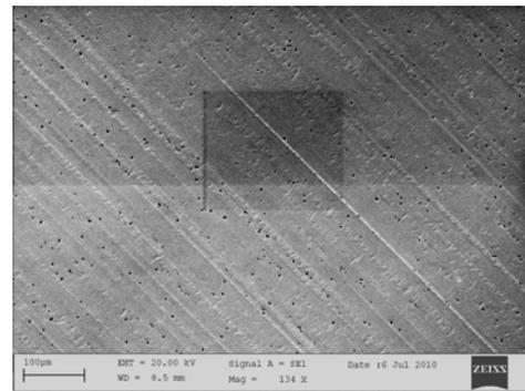
Fig. 7 (d) SEM image of lanthanum manganite  $\text{La}_{0.98}\text{Mn}_{0.02}\text{O}_3$  fibre at  $800^\circ\text{C}$
